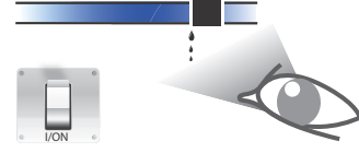
Şekil 28 Çalıştırdıktan sonra sızıntı kontrolü yapın.
