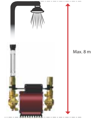
Şekil 33 Maksimum statik basınç
