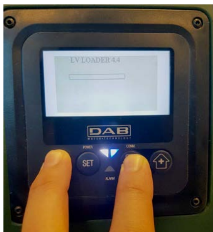
Figura 9C – Accesso al Loader per aggiornamento e.sybox mini3 Sw 1.X
