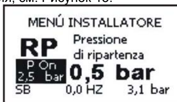
Рисунок 13: Настройка давления нового включения
